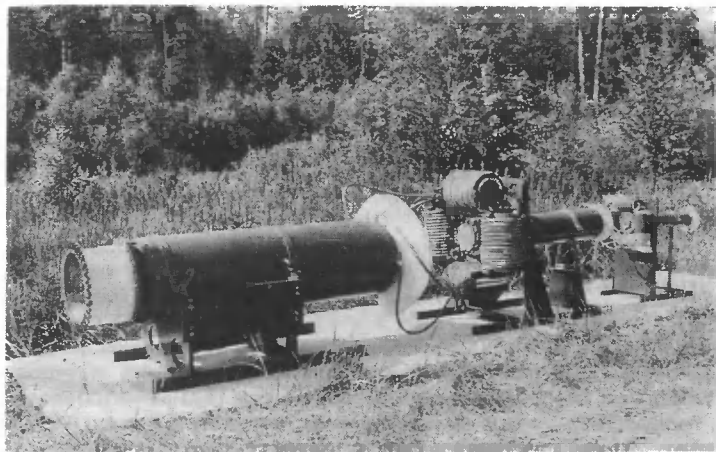
Каскадный генератор МК-2, выпускаемый Ленинградским научно-производственным объединением «Электрофизика». Устройство состоит из трех генераторов с трансформаторной связью между собой; каждый предыдущий генератор служит источником энергии для последующего. Таким образом достигается высокий коэффициент усиления энергии ( 10^4 ) и эффективное преобразование энергии взрыва (до 10 %). Выходная энергия генератора — 1,5 \cdot 10^7 Дж.
